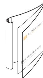
**2** Die beschriftete Papiereinlage positionieren und mit der Abdeckung unter die Nut schieben.
