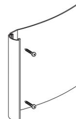
**1** Das Clipprofil aufklappen und die Abdeckung entnehmen. Nach dem Setzen der Dübel das Schild mit zwei Schrauben in der gewünschten Position und Ausrichtung anbringen.
